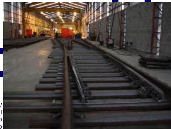
Travessão e AMV da Arcelor Mittal para inspeção no pavilhão ampliado
