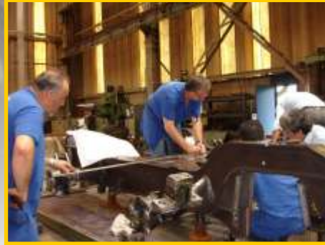
Inspeção da armação do Truque
