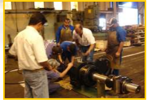
Inspeção da primeira montagem de Rodeiro Motor Metrô Brasília
