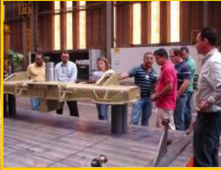
Travessa - Truque MDF em inspeção pelo Cliente
