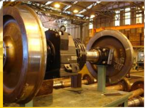
Rodeiro Motor em processo de eixamento
